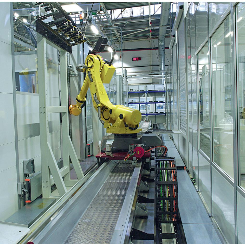
1 Das RoboFMS von Fastems verkettet sämtliche für die Fertigung erforderlichen Prozessschritte in einem System. Es handhabt sowohl Werkstücke als auch Werkstückpaletten (© Martinus Menne)
