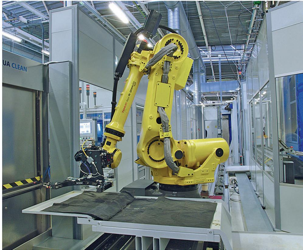
3 Unmittelbar nach der Erstbearbeitung der Werkstücke transportiert der Roboter die Halbfertigteile zur Reinigungsanlage (© Martinus Menne)
